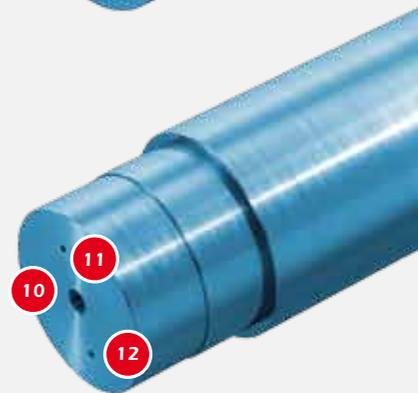
Die Hauptwelle der Windturbine besteht aus geschmiedetem, vergütetem Stahl. Sie überträgt Drehzahl und Drehmoment der langsam drehenden Rotornabe. Durch das Getriebe wird diese geringe Drehzahl in eine hohe Drehzahl umgewandelt, wodurch der Generator angetrieben und letztendlich kinetische Energie des Windes in elektrische Energie umgewandelt wird.
