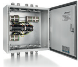
Anschlussbox zur Strommessung Zur einfachen und fehlerfreien Strom- und Spannungsmessung an stromführenden Leitern im Turm, die nach dem U/I-Umrichter angeordnet sind.
