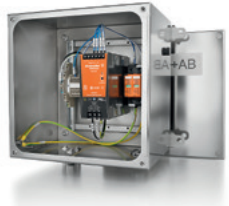
Anschlussbox Anemometer Zum Anschluss von Versorgungs- und Signalübertragungsleitungen für das Anemometer. Ein zusätzlich eingebautes Überspannungsschutzmodul schützt die nachgelagerten elektrischen Komponenten im Fall eines Blitzschlags.
