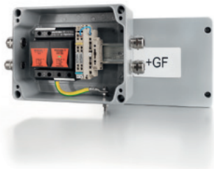
Überspannungsschutz Flugbefeuerung Multifunktionale Anschlussbox für den Gondelbereich mit Überspannungsschutzmodulen und Relaisbausteinen. Schützt die Anlage bei Blitzeinschlägen und übermittelt digitale Zustandsmeldungen der Flugbefeuerung.
